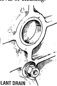
COOLANT DRAIN ON ENGINE BLOCK
