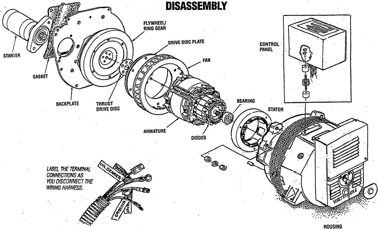
LABEL THE TERMINAL CONNECTIONS AS YOU DISCONNECT THE WIRING HARNESS.
