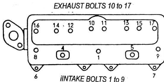
CYLINDER HEAD BOLT TIGHTENING SEQUENCE
